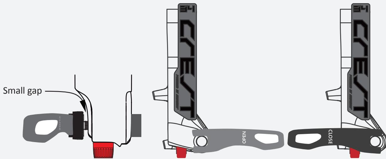
4. 若把手太緊而無法合上，請勿強迫鎖緊，拆下貫通軸並逆時針調整非驅動邊的刻度螺母一個刻度，重覆此動作直到把手平順且穩固的鎖緊。
