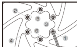
Fig. C-1 Séquence d'assemblage du rotor
