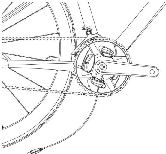
充電ケーブルを USB 電源に接続します。出力電流が 1~2A の USB 充電器（AC アダプター）を使用することをおすすめいたします。ケーブルを Power Halo の充電ポートに接続すると、Power Halo は直ちに充電を開始します。
