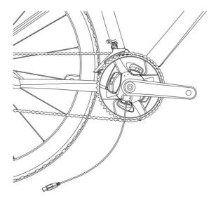
Conecte el cable de carga al puerto USB. Si desea obtener resultados mejores, le recomendamos que utiliza un cargador USB específico con una corriente de salida de 1 o 2 A.
