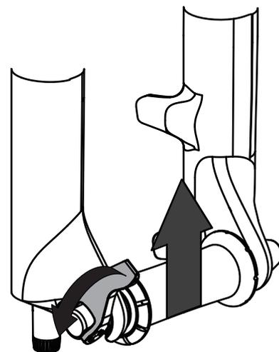
2. Con la palanca del sistema de liberación rápida en la posición abierta, apriete a mano todo lo que pueda la tuerca de ajuste de tensión contra la puntera de la horquilla. Consulte el manual de usuario del fabricante de la rueda para instalar la rueda delantera correctamente.
