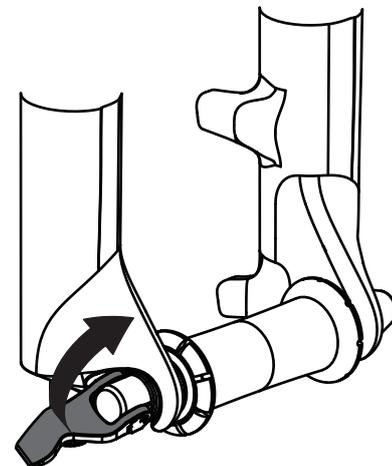
4. Si la palanca está demasiado apretada o floja para cerrarla, ábrala y regule la tuerca de ajuste de tensión correctamente. Repita el proceso según sea necesario hasta que la palanca se cierre suave y firmemente.
