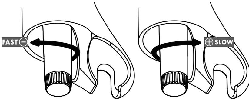
El intervalo de ajuste va desde la posición más lenta, que gira el mando del amortiguador de rebote completamente en sentido horario, hasta la posición más rápida, que gira el mando del amortiguador de rebote completamente en sentido antihorario.
