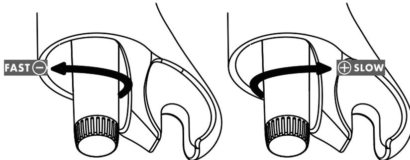
Der Einstellbereich reicht von der langsamsten Position, die den Zugstufen-Dämpfer-Knopf bis zum Anschlag im Uhrzeigersinn dreht, bis zur schnellsten Position, die den Zugstufen-Dämpfer-Knopf bis zum Anschlag gegen den Uhrzeigersinn dreht.
