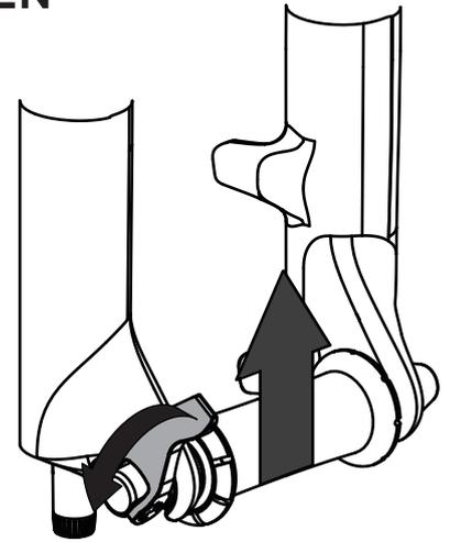
2. Ziehen Sie die Spannungseinstellschraube bei geöffnetem Hebel des Schnellspanners von Hand fest, bis er eng an der Aussparung der Gabe anliegt. Beachten Sie zur sachgemäßen Installation des Vorderrads die Bedienungsanleitung des Radherstellers.
